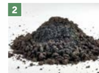
2 EXTENSIVSUBSTRAT E Dient als Vegetationstragschicht für Extensivbegrünungen.
